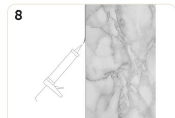
(fr) Collez les premiers 20 cm au mur avec peu de pression. De cette façon, vous pouvez repositionner le film plus facilement si nécessaire.
