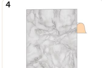
(de) Legen Sie die Folie flach hin und lassen Sie sie so lange mit dem Motiv nach oben liegen bis sie eben ist. Beschweren Sie die Folie ggf., damit sie nicht zurückrollt.
